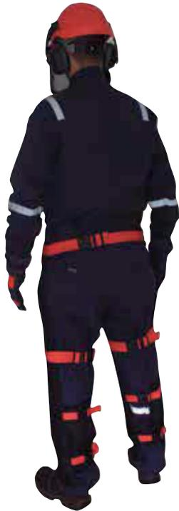
El material, **felpa de yute** al quedar expuesta por corte en el pantalón produce una respuesta “explosiva” que traba la cadena de la moto sierra de manera efectiva contra la barra y el piñón, lo que detiene la acción de corte de forma rápida y segura en cuestión de mili segundos.
