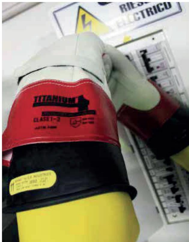
Los guantes protectores TITANIUM® están fabricados en flor de vacuno hidrofugado, con tratamiento retardante a la flama. Cuentan con refuerzo en el pulgar para mayor durabilidad, se deben usar siempre sobre los guantes aislantes eléctricos, para proporcionar la protección mecánica necesaria contra cortes, abrasiones y punzadas.
