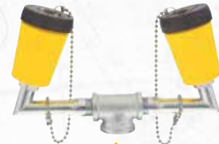
Modelo 01052111A Conjunto de lavajos con aspersores y cubiertas de ABS, "Y" de BCP, cadena tipo cordón de SS, entrada de 1/2" / 1.3 cm, 0.4 gpm / 1.5 lpm, para portátil autocontenido
